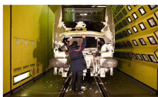
Phase de tests hivernaux préalable à la mise en service, dans l'une des meilleures chambres climatiques
