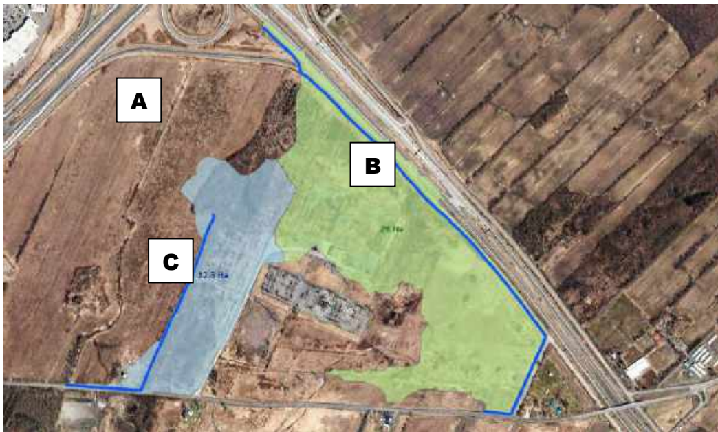
Figure 6 : Extrait du plan de travail illustrant le bassin versant des unités drainantes secondaires, délimités à l'aide du modèle numérique de terrain.
