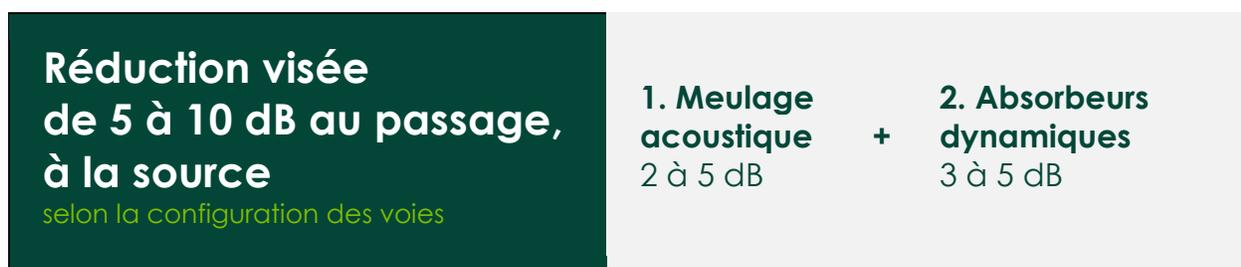
Figure 1 : Réduction sonore visée avec les mesures d'atténuation
